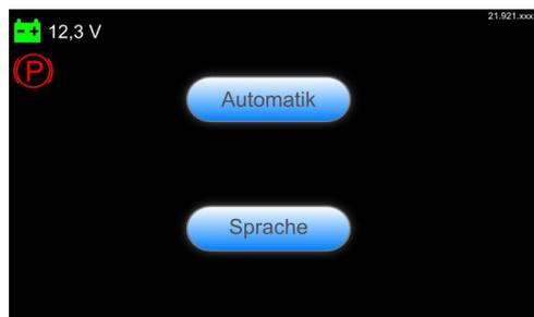
Leuchtet das Symbol der Park-Bremse (Handbremse) links oben in der Anzeige, ist die Parkbremse aktiviert. Sollte das Symbol nicht sichtbar sein – ist die Handbremse nicht aktiviert.
