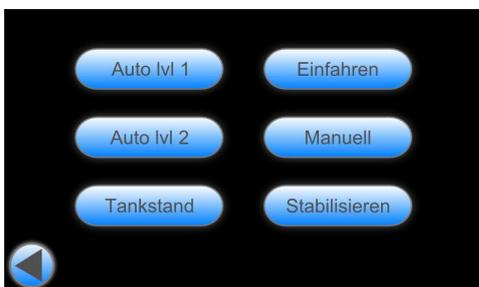
Taste > Manuell < gelangen Sie in das Menü wo Sie die Stützen am Fahrzeug manuell steuern können
