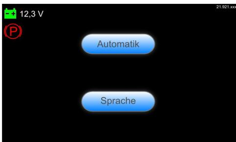
Zusätzlich wird Ihnen in der Anzeige – links oben – die Batteriespannung und die Anzeige der Parkbremse angezeigt. Leuchtet das Batteriesymbol „grün“ – ist die Batterie voll also im optimalen Bereich Leuchtet das Batteriesymbol „orange“ – ist die Batteriespannung unter 13 Volt – bitte beobachten Leuchtet das Batteriesymbol „rot“ – ist die Batteriespannung unter 12 Volt und die Spannung ist im kritischen Bereich – das System bringt eine Fehlermeldung
